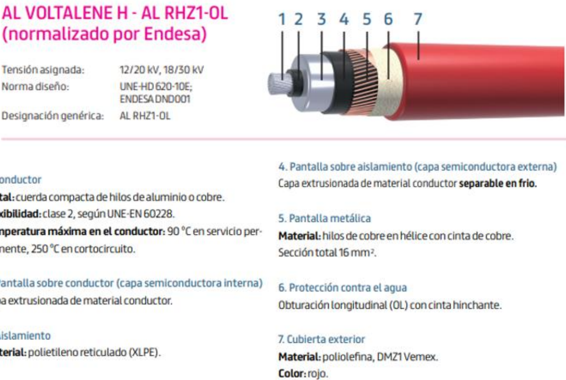
Figura 8. Características del cable AL VOLTALENE H-AL RHZ1 -OL XPLE 18/30 kV.
